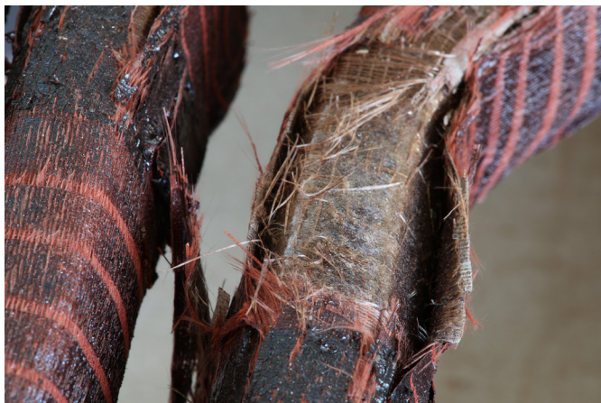
Gerissenes Deckband eines gealterten Prüflings
