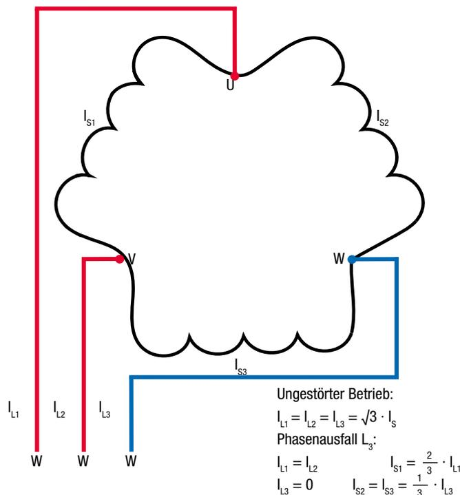
Bild 2.2: Dreieckschaltung bei Phasenausfall
