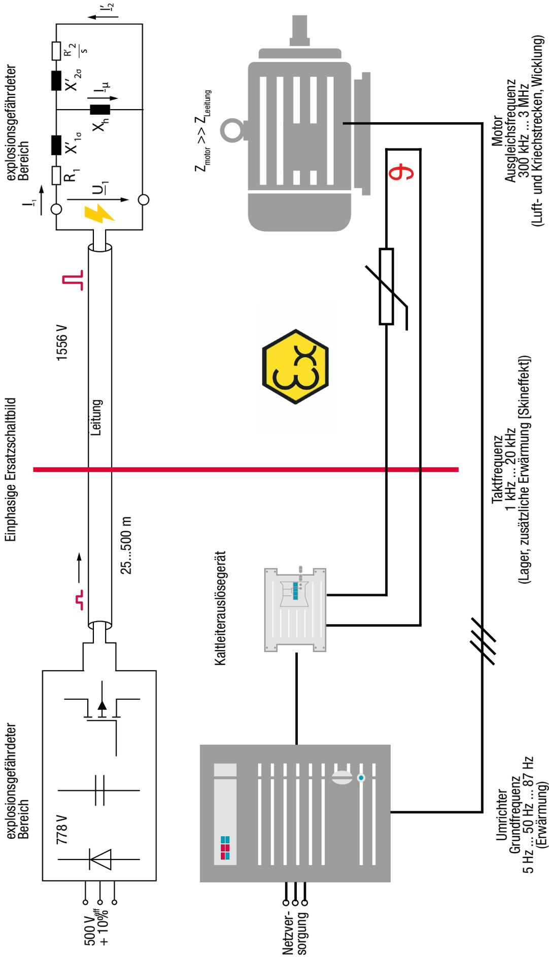
Bild 3.1: Entstehung von transienten Überspannungen an einem frequenzumrichter gespeisten Antrieb
