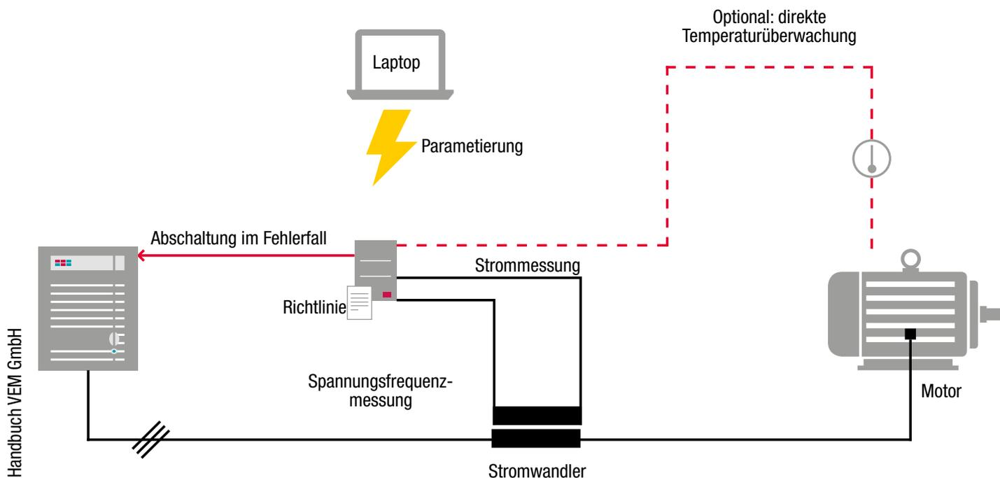
Bild 3.10: Überwachung des Motors bei Umrichterbetrieb
