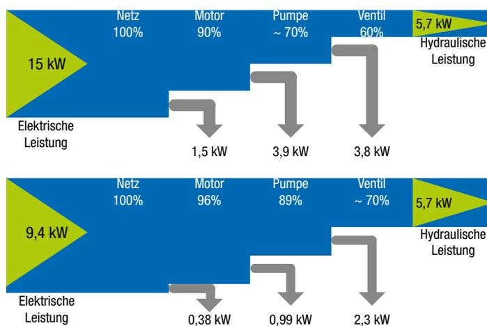
Bild 3.6: Von der elektrischen zur hydraulischen Leistung
