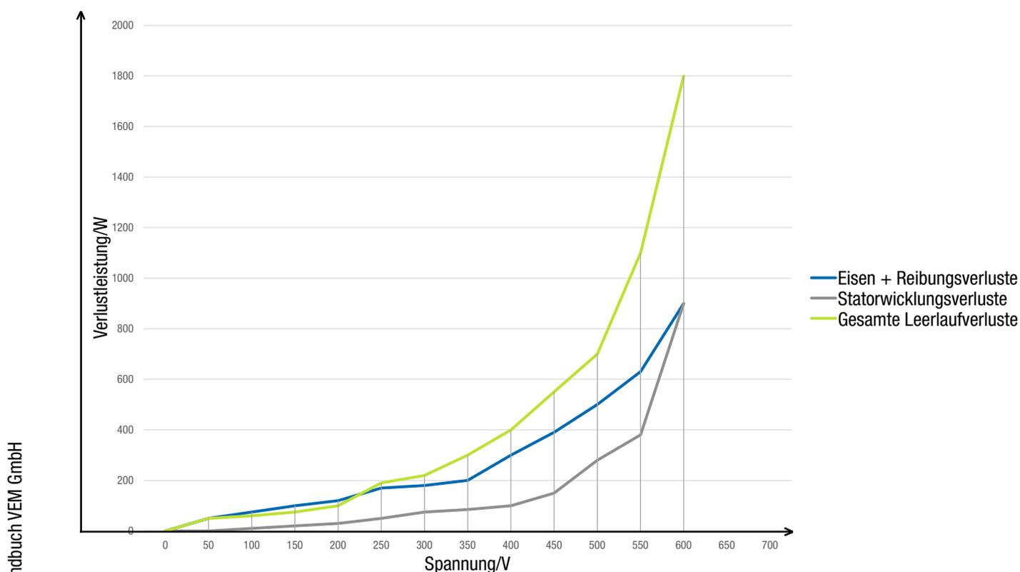
Bild 2.1.: Verlauf der Leerlaufverluste in Abhängigkeit der Spannung
