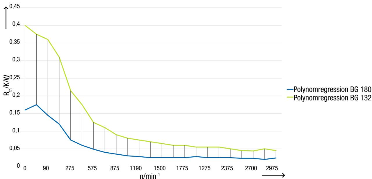
Bild 3.2: Verlauf des thermischen Widerstandes zur Umgebung in Abhängigkeit der Drehzahlen
