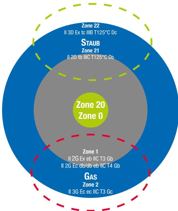
4.1. Eigene Darstellung der Ex-Zonen auf Basis der DIN EN 60079-0 die den Explosionsschutz beeinflussen (andere Frequenz, Leistung, Kühlmitteltemperatur, Einsatz am Frequenzumrichter usw.), kann eine Zusatz- oder Neubescheinigung erforderlich werden.
