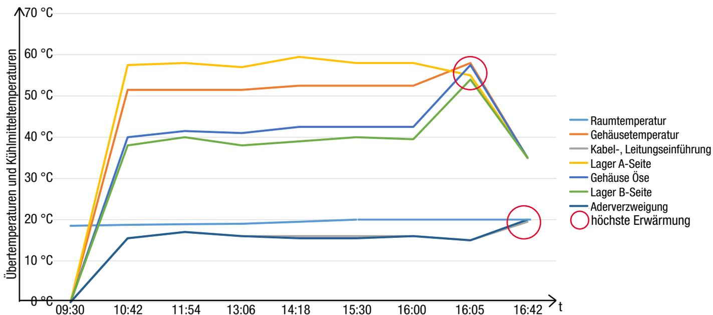
Diagramm 1.3: Beispielhafter Verlauf der Gehäusetemperatur während des Versuchs
