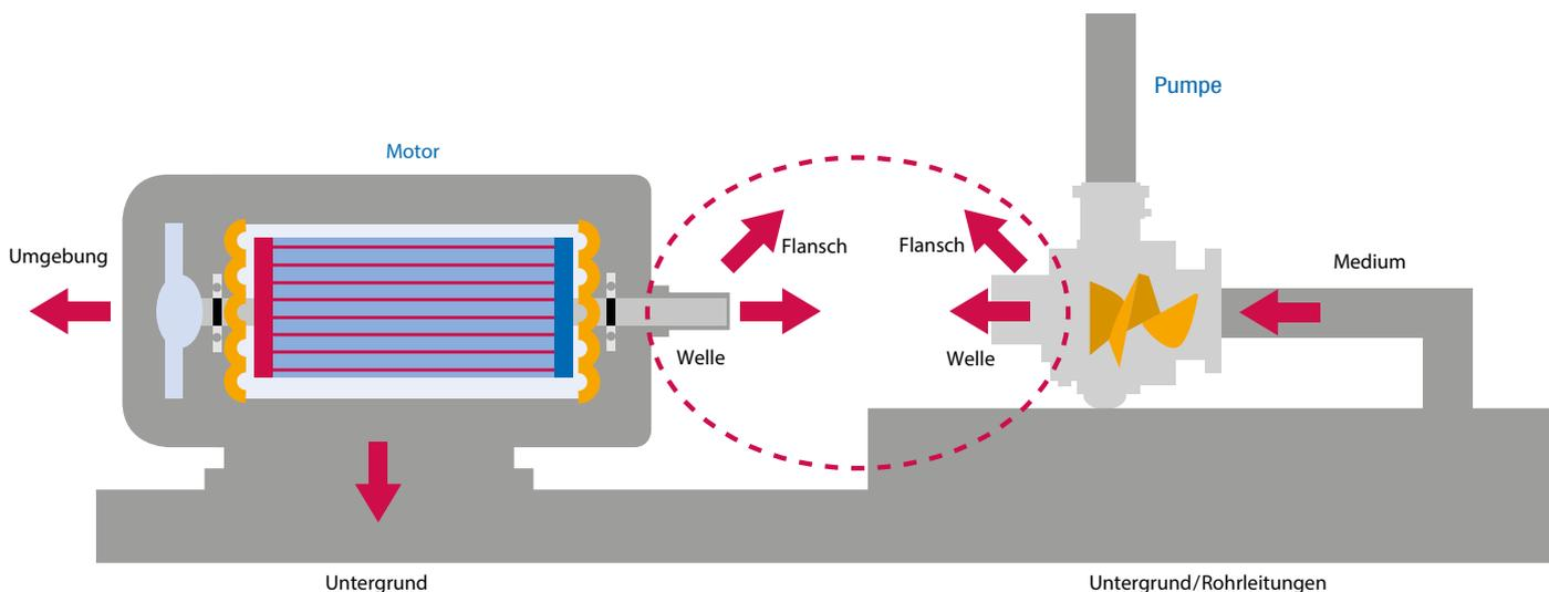
Bild 2.6: Zusammenbau Motor-Pumpe
