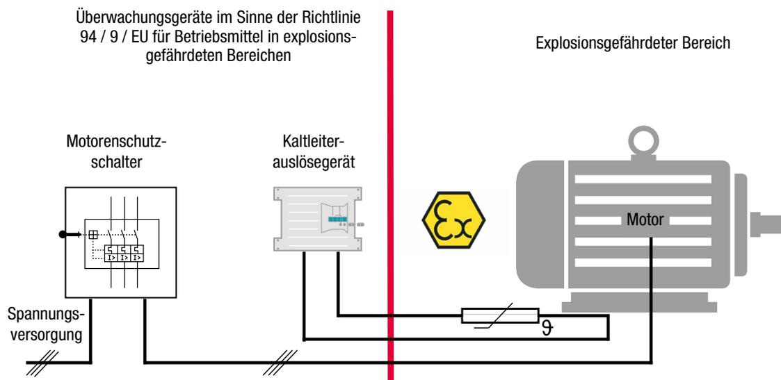
Bild 2.5: Schutz des Motors durch Strom- und Temperaturüberwachung
