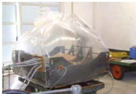
Bild 1.4: Stoßspannungstest an einem Wicklungsmodell unter Gas (Foto: PTB Braunschweig)
