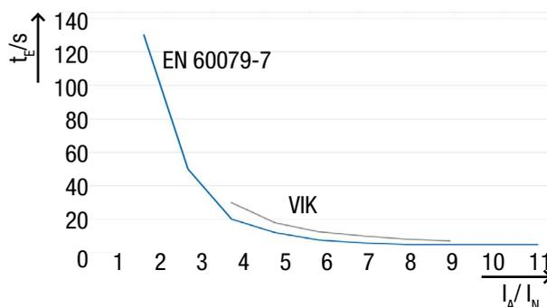
Bild 2.4: Auslösekennlinie für stromabhängige Motorschutzgeräte nach EN 60079-7, sowie VIK Empfehlung
