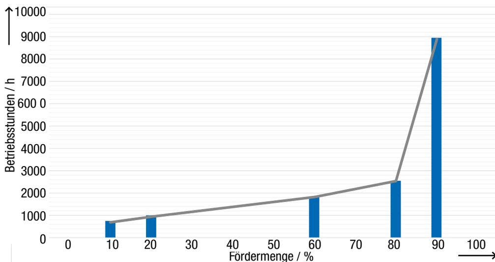
Bild 3.7: Amortisationszeit des Frequenzumrichters (Anschaffungspreis 2000 €) in Abhängigkeit Verhältnis Fördermenge zu Bemessungsfördermenge
