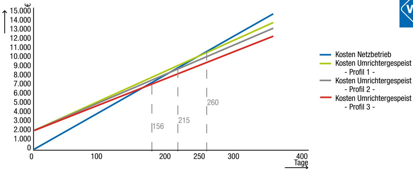
Bild 3.9: Energiekostenverlauf über der Zeit für den Betrieb am Netz und für den Frequenzumrichterbetrieb. Anschaffungskosten des Frequenzumrichters: 2.000,00€
