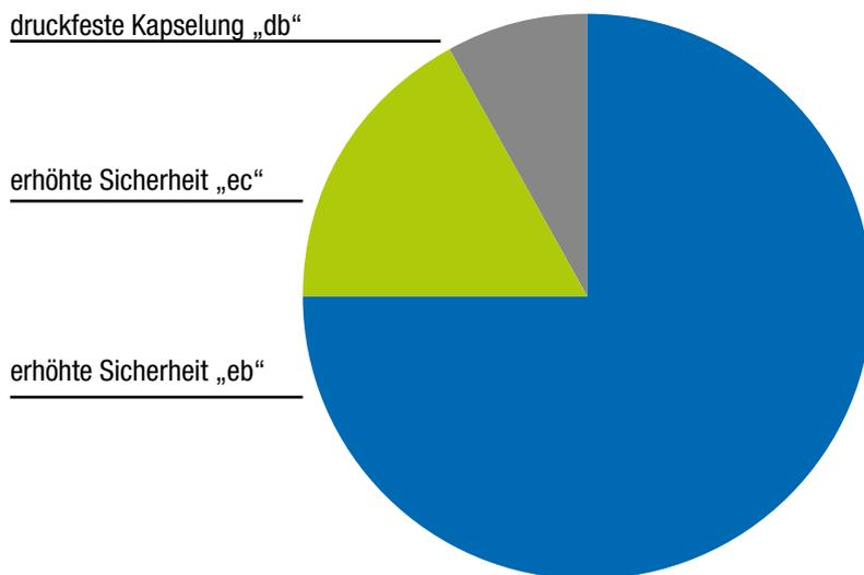
Bild 1.1: Verteilung der Zündschutzarten bei netzgespeisten Antrieben
