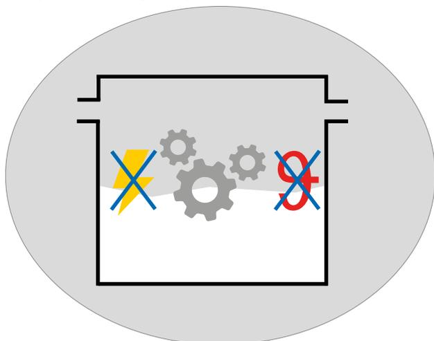
Bild 2.7: Kombination aus den Zündschutzarten „c“ und „k“ bei einem Getriebe („c“ und „k“ ... mechanischer Explosionsschutz)
