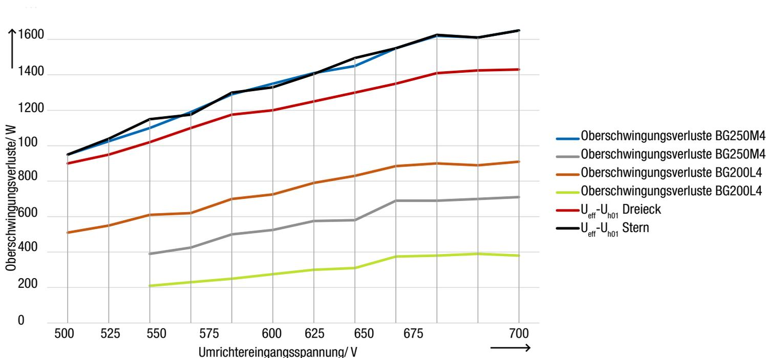
Bild 3.5 Abhängigkeit der Oberschwingungsverluste von der Umrichtereingangsspannung
