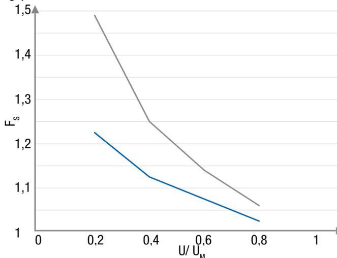
Bild 7.1: Sättigungsfaktor in Abhängigkeit des Verhältnisses Prüf- zu Nennspannung
