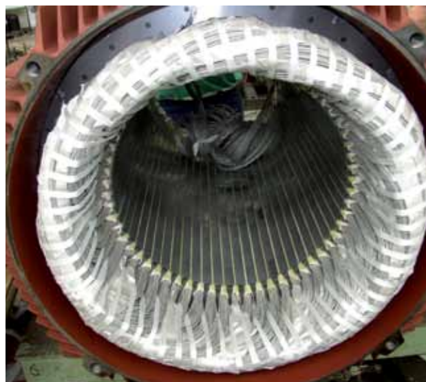
Abb. 4: Baureihe KV.R, Stator, noch nicht imprägniert
